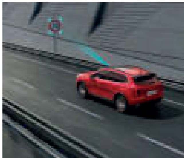
Жол белгілерін тану жүйесі
